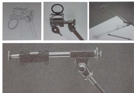
Figura 5 – Aparato Óptico – modelos Câmera Lúdica ou Clara: usada a partir de 1806. Fontes: HOCKNEY, 2001
